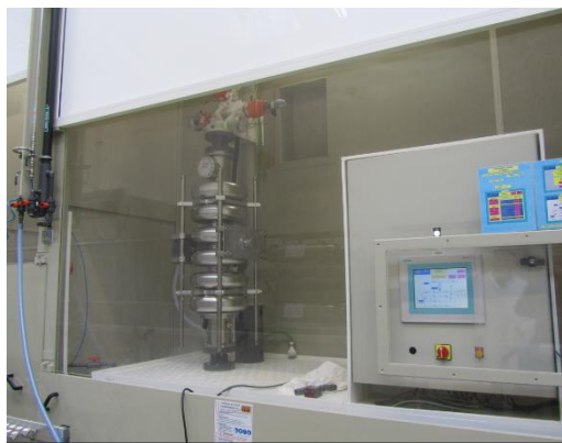
Figure 3: Vue d'une cavité en cours de traitement dans le compartiment 2 du tunnel de traitement sur le précédent équipement de traitement chimique (en cours de démantèlement).
