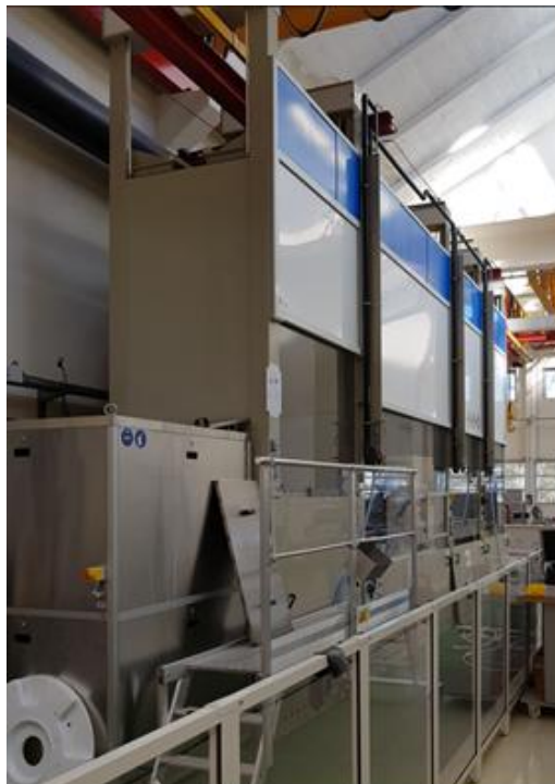
Figure 6 : Photo du tunnel de traitement comprenant 4 compartiments.
