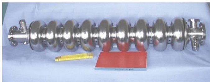
Figure 1: Cavité supraconductrice à 9-cellules de forme elliptique et fonctionnant à 1300 MHz.
